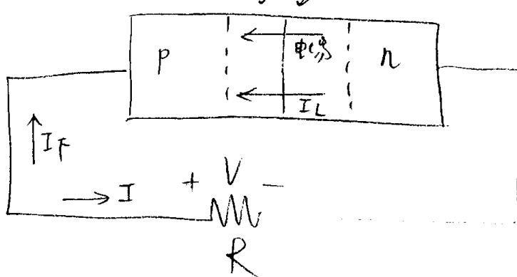
光电流  $I_L$  很明显由 p 端流出元件，且永为逆向偏压方向，故提供功率元件
