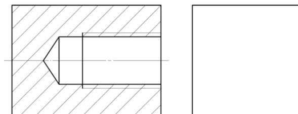
六、請利用圓規、直尺，以四心法近似橢圓，繪出下列物件之圓孔在右側視圖中所呈現之圖形。孔壁與孔底之虛線不必繪製，作圖過程之輔助線條請保留。(10分)
