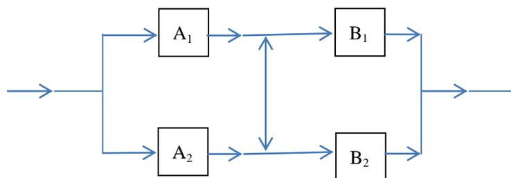
(三)可靠度方塊圖如下，機率各為0.9，系統可靠度為何？（15分）
