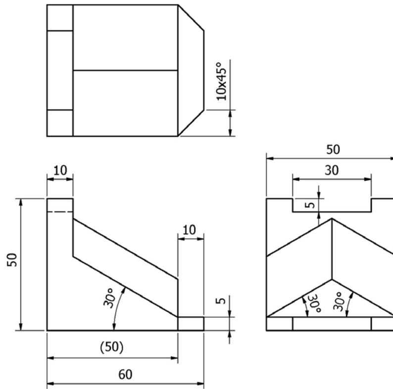
三、請依下列正投影所示之尺度，以比例 1：1 繪製正投影視圖，不用標註尺度。視圖包含前視圖、右側視圖及俯視圖，視圖中 A、B 兩處之厚度相同（前視圖、右側視圖須依剖面線繪製剖視圖）。（25 分）
