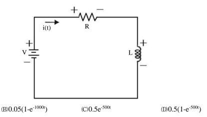
27 如圖所示之 RL 電路,在時間 t=0 時 SW 閉合,求跨於電阻之電壓表示式 VR(t)等於多少伏特(V)?
