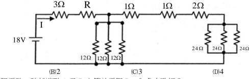
7 如圖示電阻電路,跨越端點 A 及 B 之等效電阻 RAB 為多少歐姆?
