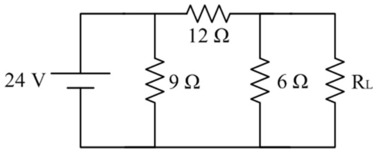
20 如圖所示之電路，求電阻  $R$  之最大功率值約為何？
