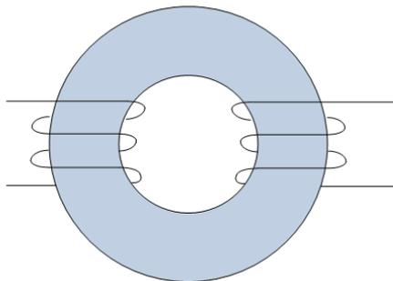
22 線圈 N1 與線圈 N2 的互感  $M=5\text{ H}$ ，若 N1 之電流與時間  $t$  的關係可表示成  $5+t$ ，求在 N2 產生的互感應電動勢為何？
