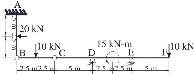
二、如下圖所示之剛架，A點為鉸接端，D點為滾支承，在C點施加一個80 kN的力量，用虛功法 (Virtual Work) 求B點旋轉角 (各桿件之E、I均相同)。(未依指定方法作答，整題以零分計。)(25分)
