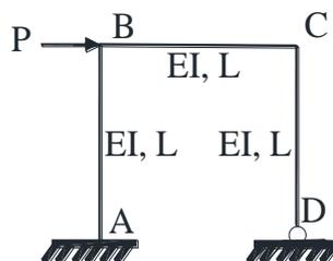
四、利用彎矩分配法 (Moment Distribution Method) 求下圖所示剛架各桿件端點彎矩，其中 A 及 C 點為固接端，D 點為滾支承 (水平桿件之彈性模數及慣性矩均為  $EI$ ，垂直桿件之彈性模數及慣性矩為  $2EI$ )。(注意：未依指定方法作答，整題以零分計。)(25 分)
