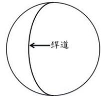
[D] 42. 筒狀壓力容器，組成方式由細長鋼板沿軸心方向以螺旋狀纏繞後沿邊緣銲接，如右圖所示，鋼板彈性模數 $E = 200$  GPa，柏松比(Poisson's ratio)  $\nu = 0.3$ ，容器壓力為800 kPa，請計算經線方向 $\epsilon_2$ 應變為何？
