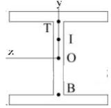
[A] 38. 工字型梁承受一垂直剪力 $V = 45$  kN，斷面如右圖所示，請計算最小剪應力為何？
